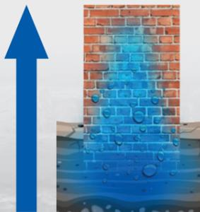
L'umidità di risalita che comporta muri deteriorati, odore di muffa, ambienti insalubri, importanti costi di riscaldamento, è un problema frequente soprattutto nelle abitazioni storiche, in monumenti, chiese ed edifici che non prevedono un isolamento dal terreno. Risolvere il problema dell'umidità di risalita alla radice significa agire dall'interno, **sulle cause**, bloccando la risalita capillare dell'acqua.
